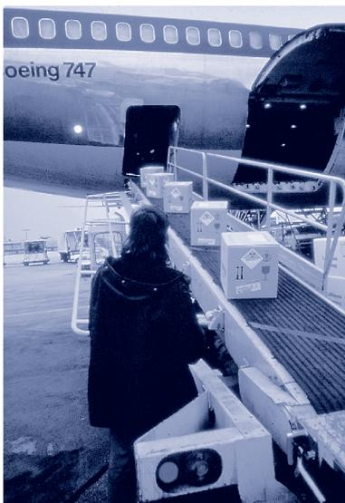
Radioaktive Stoffe für medizinische Zwecke mit kurzlebigen Radionukliden werden wegen der Eilbedürftigkeit in Luftfahrzeuge verladen. Die äußere Strahlung ist gering.
