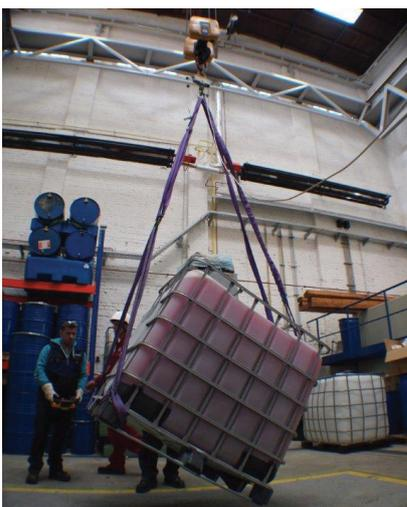
Bevor Verpackungen für den Transport gefährlicher Güter zugelassen werden, müssen sie entsprechend den Empfehlungen der Vereinten Nationen geprüft werden. Im Bild ist eine Fallprüfung eines IBC zu sehen. Weitere Testkriterien sind Druck-, Stapel- und chemische Beständigkeit.
